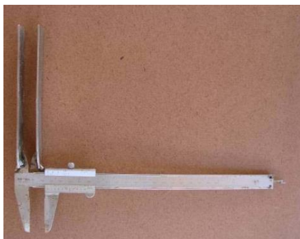
Figura 4 –Paquímetro de aço inoxidável, com precisão de milímetros, adaptado com espátulas soldadas para medição das aberturas de galerias do caranguejo-uçá, nas áreas de mangue de Canavieiras e Caravelas, Bahia (foto: Schmidt et al. 2008).
