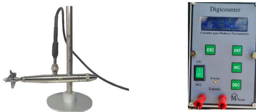
Figura 3. Modelo do micromolinete utilizado para obter os dados de vazão
